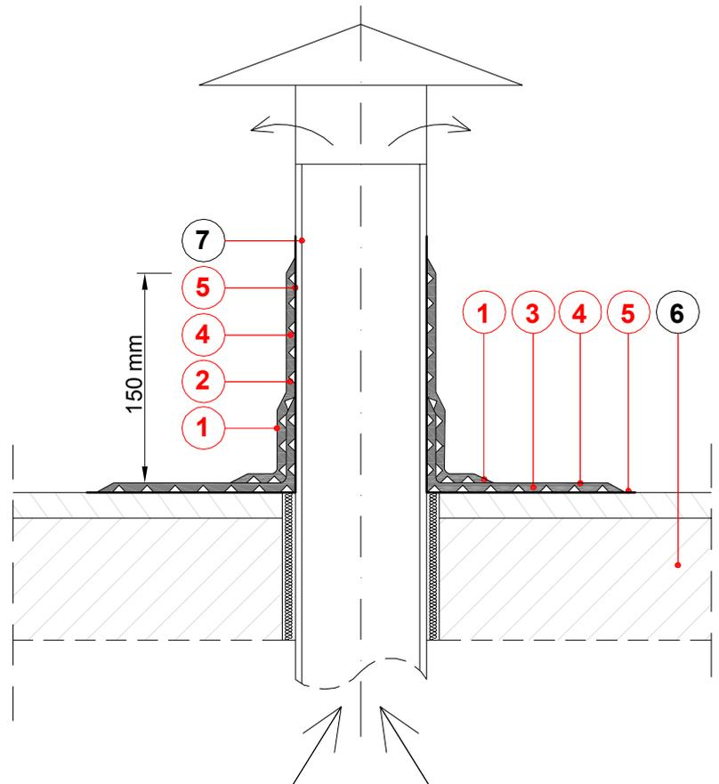
Enke Vliesformteile: Manschetten aus Polyflexvlies (Flächengewicht 110 g/m<sup>2</sup>)
