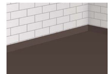
10 Fertige, belegreife Abdichtung
