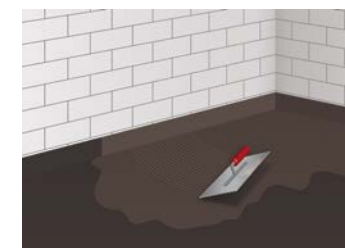
9 Auftrag der 2. Abdichtungsschicht
